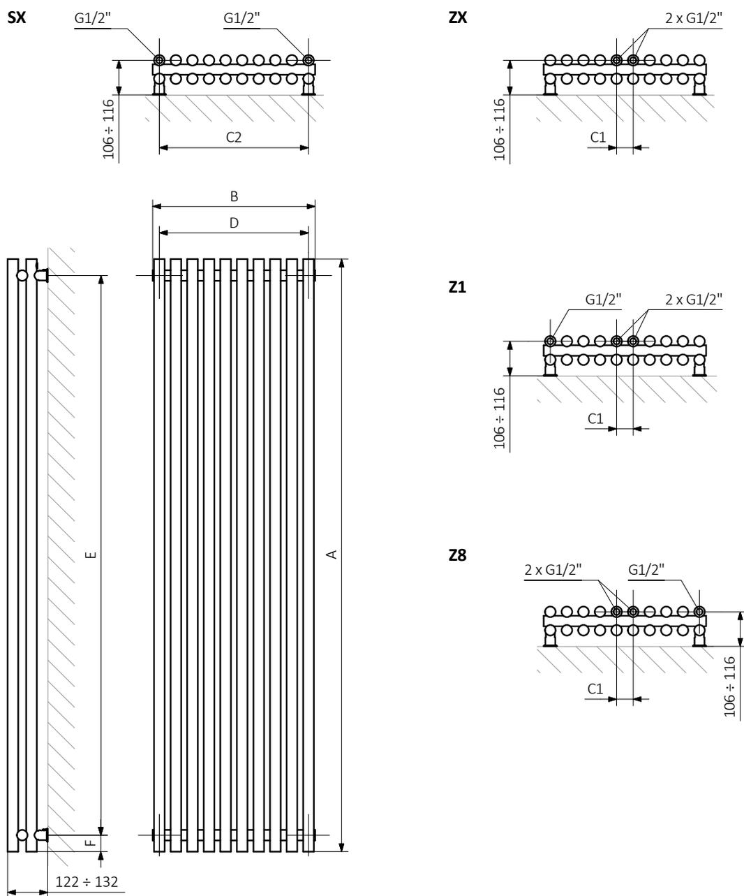
A - Höhe B - Breite C1-C5 - Anschlussabstand D - horizontaler Wandhalterungsabstand E - Vertikaler Wandhalterungsabstand F - Abstand von der Achse der unteren Wandhalterung bis Unterkante des Kollektors
