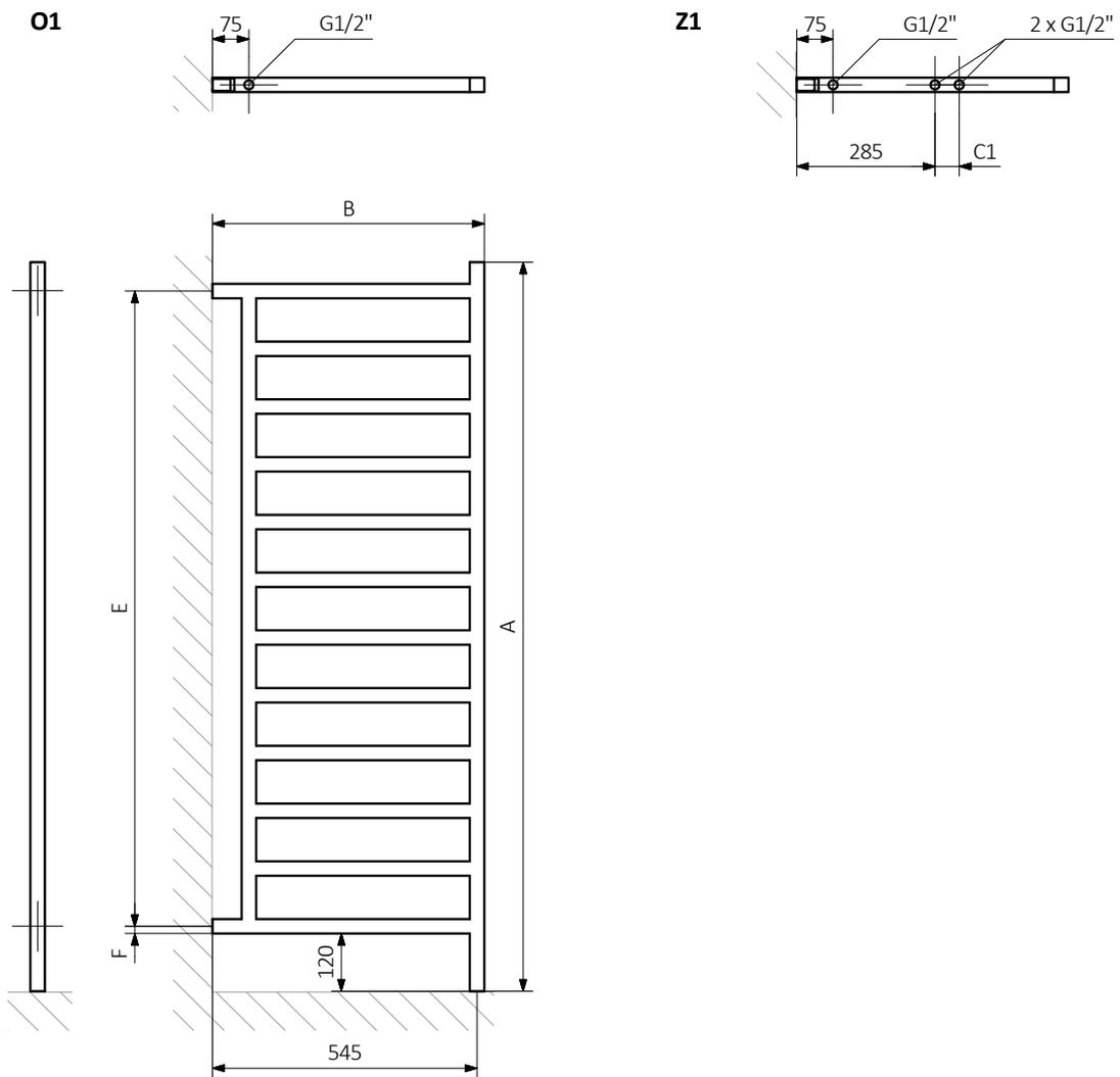
A – Höhe B – Breite C1-C5 – Anschlussabstand D – horizontaler Konsolenabstand E – Vertikaler Konsolenabstand, F – Abstand von der Achse der unteren Konsole bis Unterkante des Kollektors
