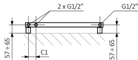
A - Höhe B - Breite C1-C5 - Anschlussabstand D - horizontaler Wandhalterungsabstand E - Vertikaler Wandhalterungsabstand F - Abstand von der Achse der unteren Wandhalterung bis Unterkante des Kollektors
