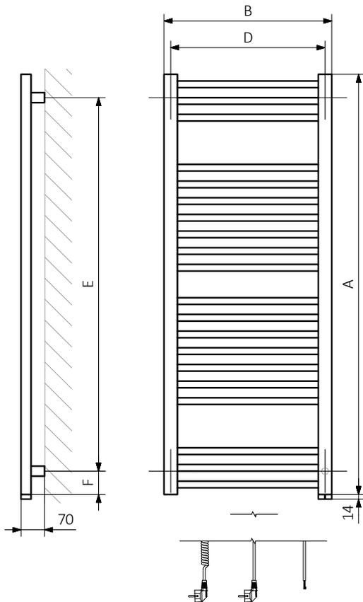
A – Höhe B – Breite C1-C5 – Anschlussabstand D – horizontaler Konsolenabstand E – Vertikaler Konsolenabstand, F – Abstand von der Achse der unteren Konsole bis Unterkante des Kollektors
