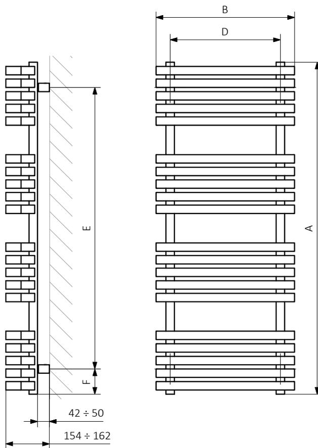
A – Höhe B – Breite C1-C5 – Anschlussabstand D – horizontaler Konsolenabstand E – Vertikaler Konsolenabstand, F – Abstand von der Achse der unteren Konsole bis Unterkante des Kollektors
