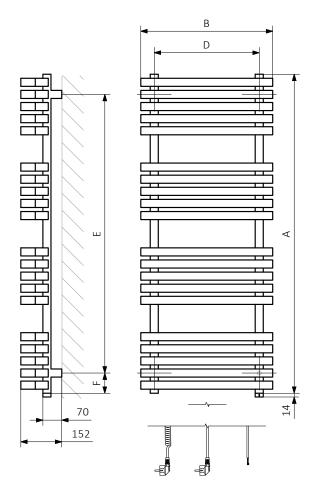
A – Höhe B – Breite C1-C5 – Anschlussabstand D – horizontaler Konsolenabstand E – Vertikaler Konsolenabstand, F – Abstand von der Achse der unteren Konsole bis Unterkante des Kollektors
