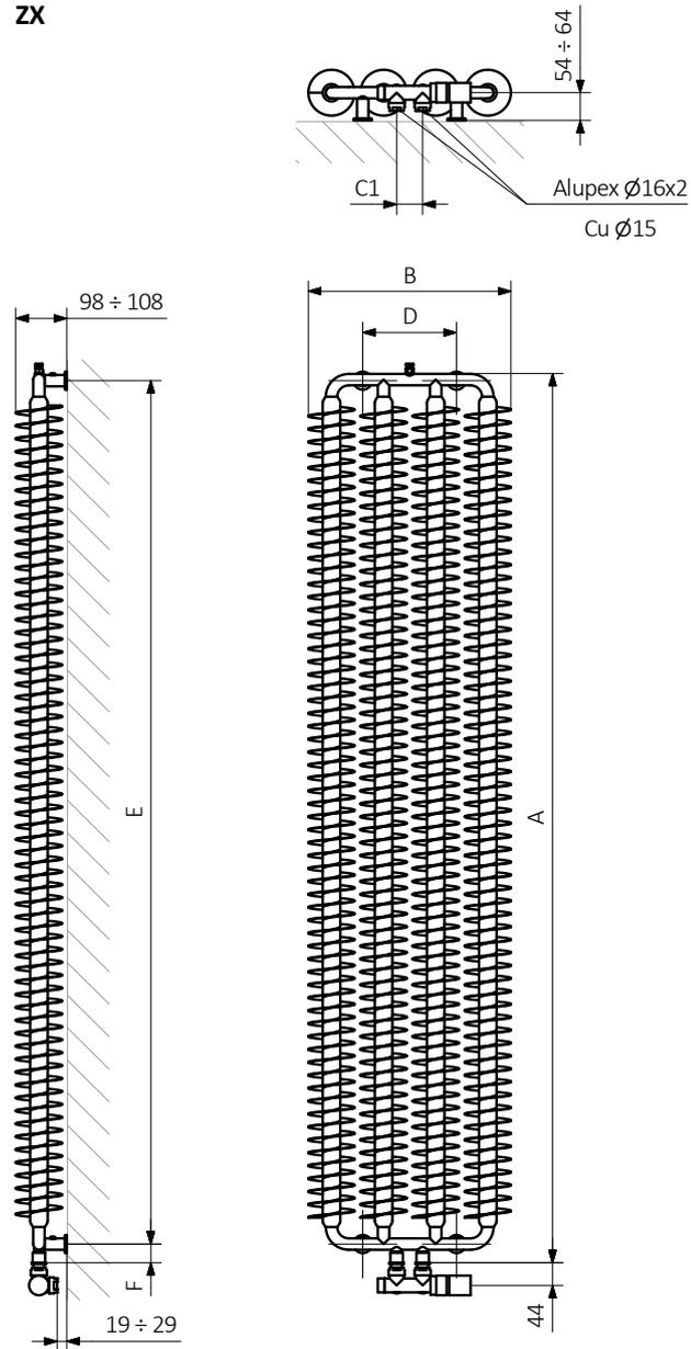
A – Höhe B – Breite C1-C5 – Anschlussabstand D – horizontaler Konsolenabstand E – Vertikaler Konsolenabstand, F – Abstand von der Achse der unteren Konsole bis Unterkante des Kollektors
