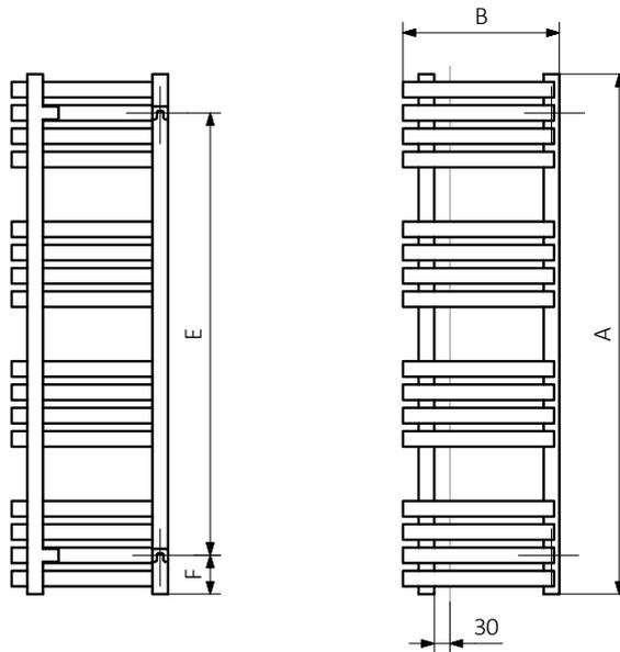
A – Höhe B – Breite C1-C5 – Anschlussabstand D – horizontaler Konsolenabstand E – Vertikaler Konsolenabstand, F – Abstand von der Achse der unteren Konsole bis Unterkante des Kollektors
