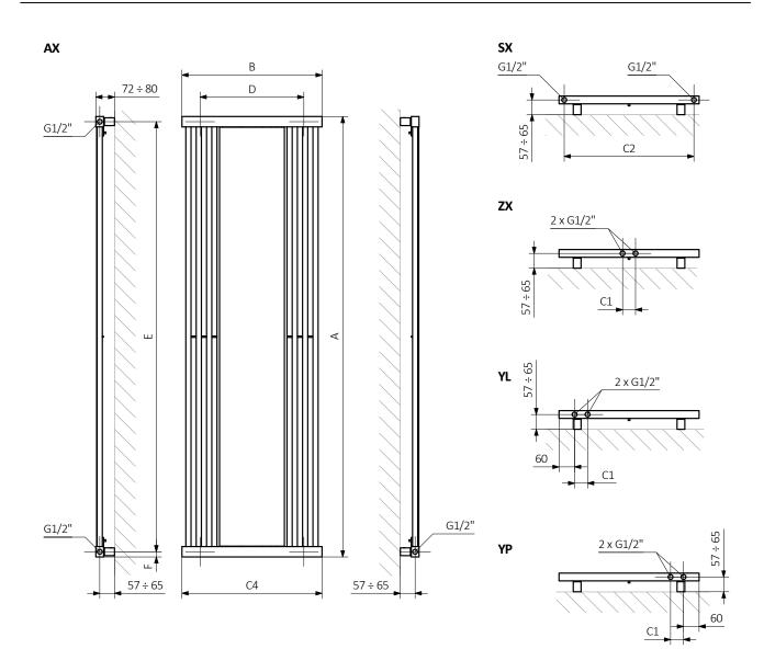
A – Höhe B – Breite C1-C5 – Anschlussabstand D – horizontaler Wandhalterungsabstand E – Vertikaler Wandhalterungsabstand F – Abstand von der Achse der unteren Wandhalterung bis Unterkante des Kollektors
