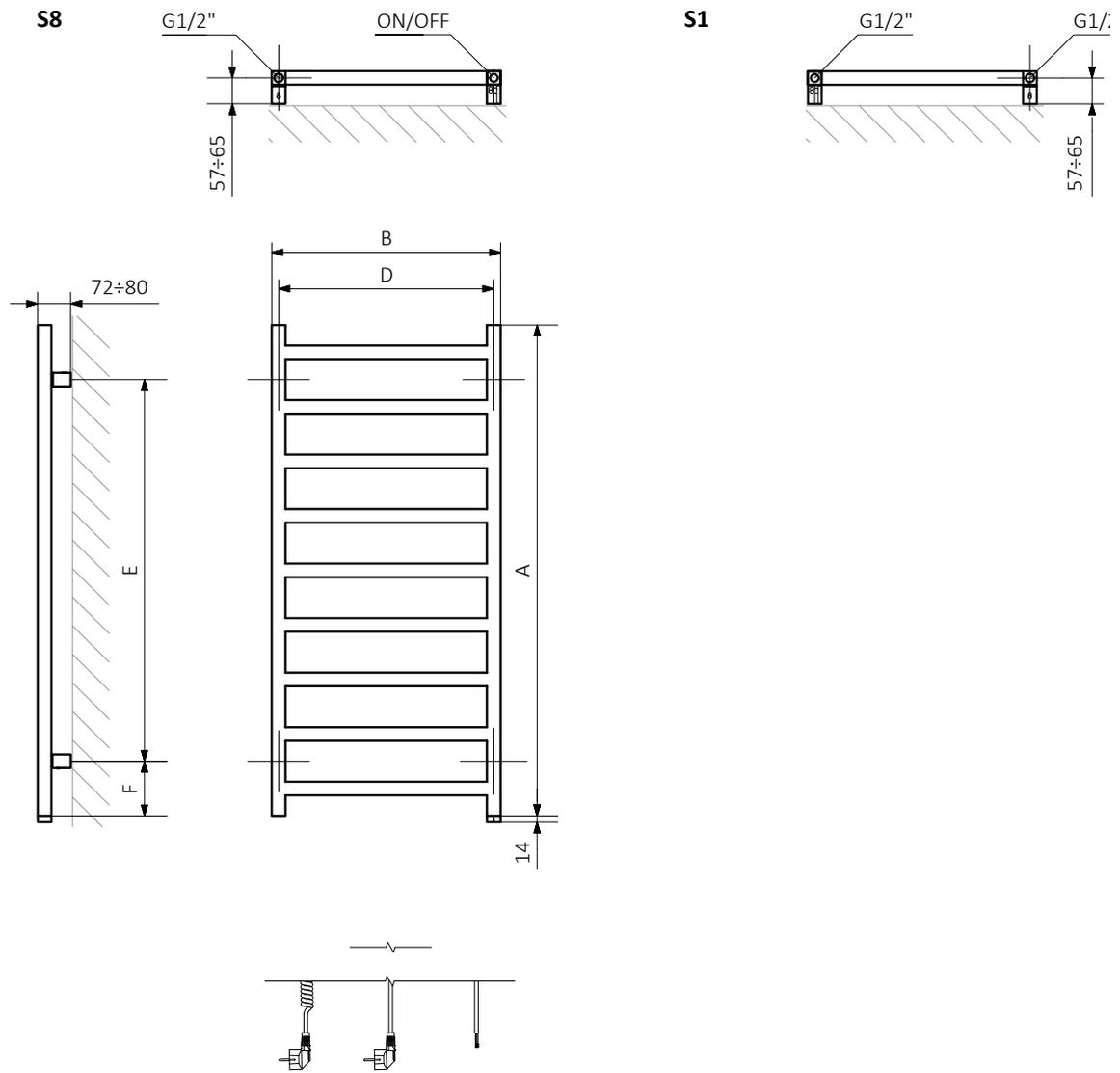
A - Höhe B - Breite C1-C5 - Anschlussabstand D - horizontaler Wandhalterungsabstand E - Vertikaler Wandhalterungsabstand F - Abstand von der Achse der unteren Wandhalterung bis Unterkante des Kollektors
