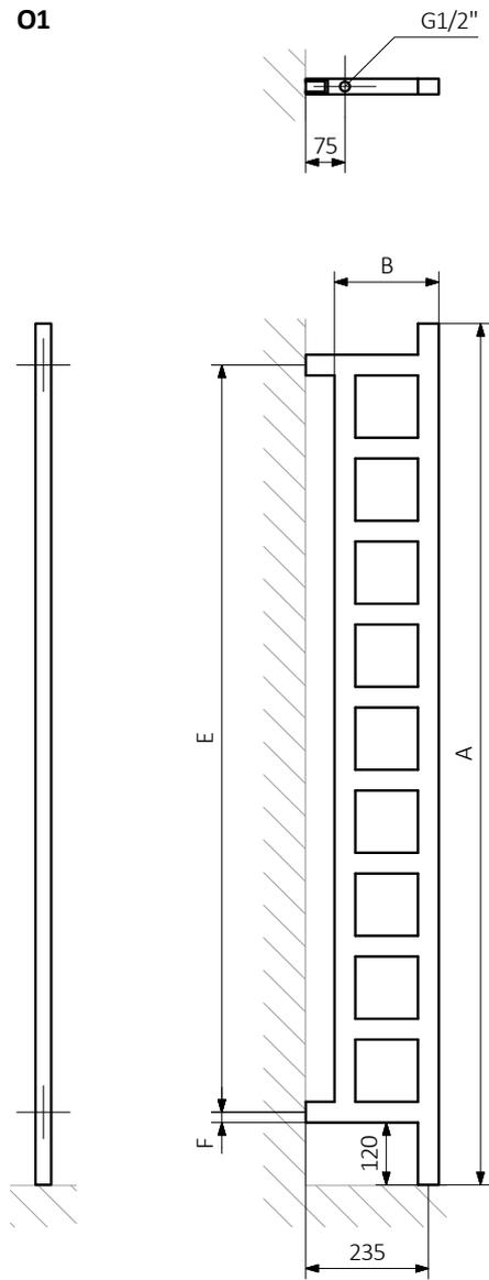
A – Höhe B – Breite C1-C5 – Anschlussabstand D – horizontaler Konsolenabstand E – Vertikaler Konsolenabstand, F – Abstand von der Achse der unteren Konsole bis Unterkante des Kollektors
