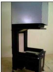
**Punkt 2.** Stellen Sie Kamineinsatz bei der Schornsteinachse und Regulieren Sie die Stellfüße mit ein Schlüssel 24. Der Kamineinsatz z muss auf die Höhe von 415mm Unterkante Zarge Rahmen ausgerichtet werden. Jetzt müssen Sie die Silbersicherungsmutter von Schrauben lösen.
