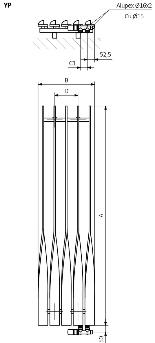
A – Höhe B – Breite C1-C5 – Anschlussabstand D – horizontaler Konsolenabstand E – Vertikaler Konsolenabstand, F – Abstand von der Achse der unteren Konsole bis Unterkante des Kollektors
