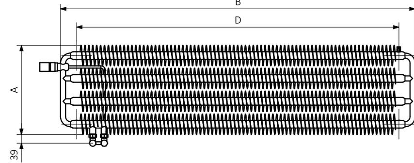
A – Höhe B – Breite C1-C5 – Anschlussabstand D – horizontaler Konsolenabstand E – Vertikaler Konsolenabstand, F – Abstand von der Achse der unteren Konsole bis Unterkante des Kollektors
