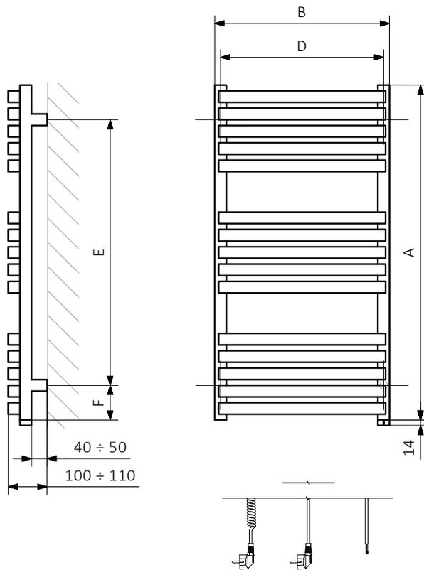
A – Höhe B – Breite C1-C5 – Anschlussabstand D – horizontaler Konsolenabstand E – Vertikaler Konsolenabstand, F – Abstand von der Achse der unteren Konsole bis Unterkante des Kollektors
