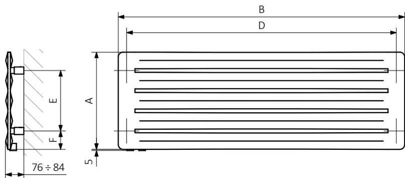
A – Höhe B – Breite C1-C5 – Anschlussabstand D – horizontaler Konsolenabstand E – Vertikaler Konsolenabstand, F – Abstand von der Achse der unteren Konsole bis Unterkante des Kollektors
