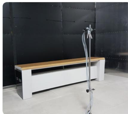
Die Prüfungen der Heizleistung der Wand- und Standheizkörper sowie der COMODO-Heizbänke wurden in einer speziell vorbereiteten Klimakammer gemäß den Anforderungen der Europäischen Norm EN-442 durchgeführt..
