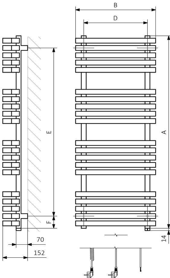
A – Höhe    B – Breite    C1-C5 – Anschlussabstand    D – horizontaler Konsolenabstand    E – Vertikaler Konsolenabstand,
