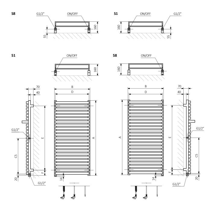
B – Breite C1-C5 – Anschlussabstand D – horizontaler Konsolenabstand E – Vertikaler Konsolenabstand, F – Abstand von der Achse der unteren Konsole bis Unterkante des Kollektors
