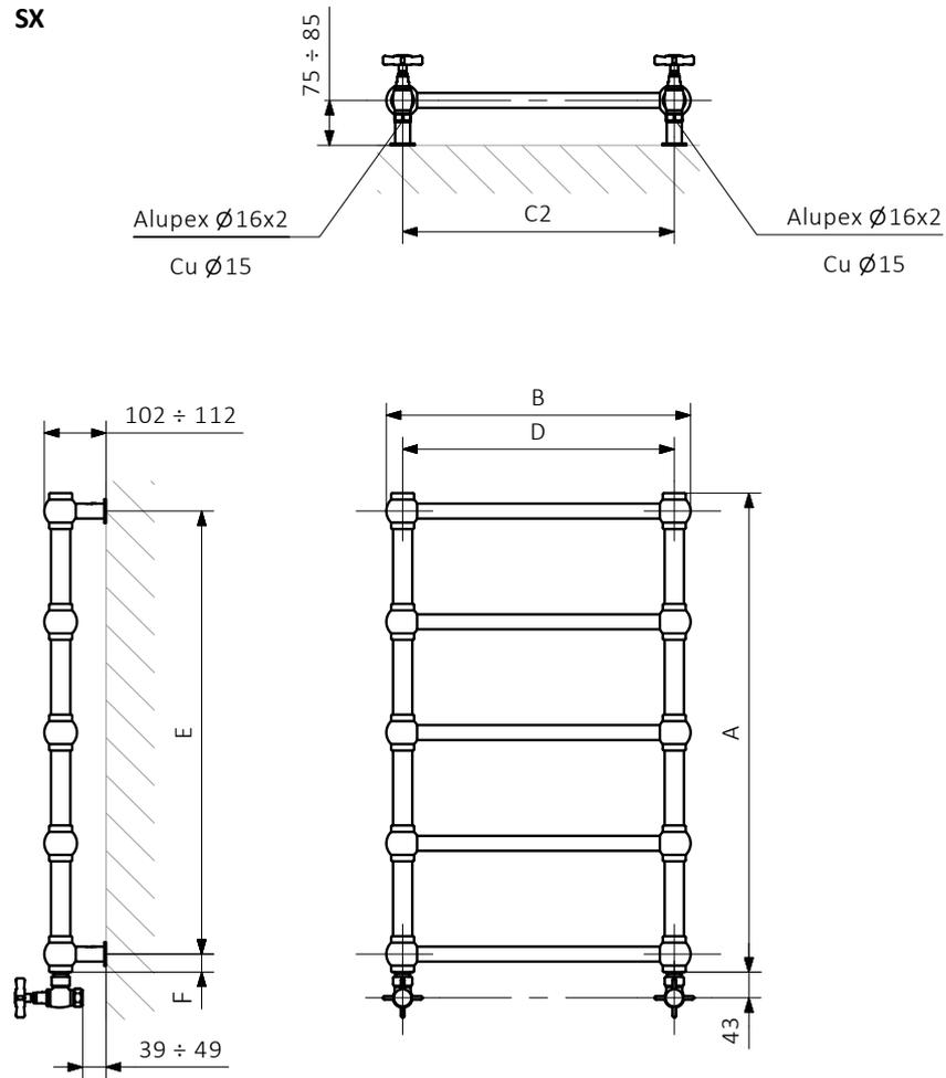
A – Höhe B – Breite C1-C5 – Anschlussabstand D – horizontaler Konsolenabstand E – Vertikaler Konsolenabstand, F – Abstand von der Achse der unteren Konsole bis Unterkante des Kollektors
