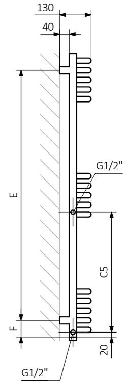
A – Höhe B – Breite C1-C5 – Anschlussabstand D – horizontaler Konsolenabstand E – Vertikaler Konsolenabstand, F – Abstand von der Achse der unteren Konsole bis Unterkante des Kollektors
