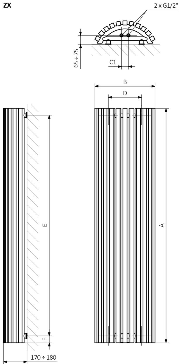
A – Höhe B – Breite C1-C5 – Anschlussabstand D – horizontaler Konsolenabstand E – Vertikaler Konsolenabstand, F – Abstand von der Achse der unteren Konsole bis Unterkante des Kollektors
