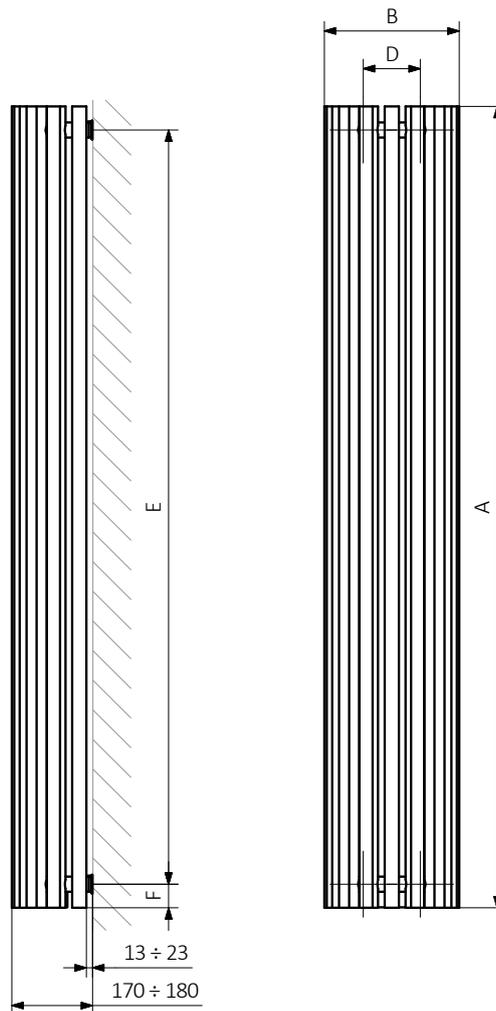
A - Höhe B - Breite C1-C5 - Anschlussabstand D - horizontaler Wandhalterungsabstand E - Vertikaler Wandhalterungsabstand F - Abstand von der Achse der unteren Wandhalterung bis Unterkante des Kollektors
