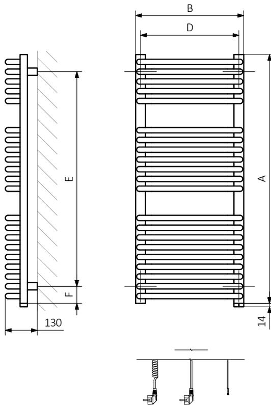
A – Höhe B – Breite C1-C5 – Anschlussabstand D – horizontaler Konsolenabstand E – Vertikaler Konsolenabstand, F – Abstand von der Achse der unteren Konsole bis Unterkante des Kollektors
