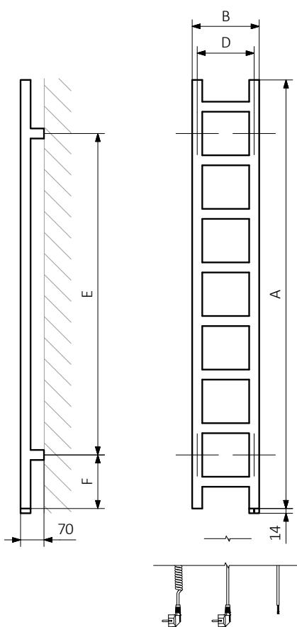
A – Höhe    B – Breite    C1-C5 – Anschlussabstand    D – horizontaler Konsolenabstand    E – Vertikaler Konsolenabstand,
