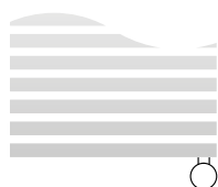
[Zeichnung 7 – Anschluss der Heizpatrone von unten, vertikal, bei einem Heizkörper mit horizontalen Querrohren] Anschluss E1, E8, EX
