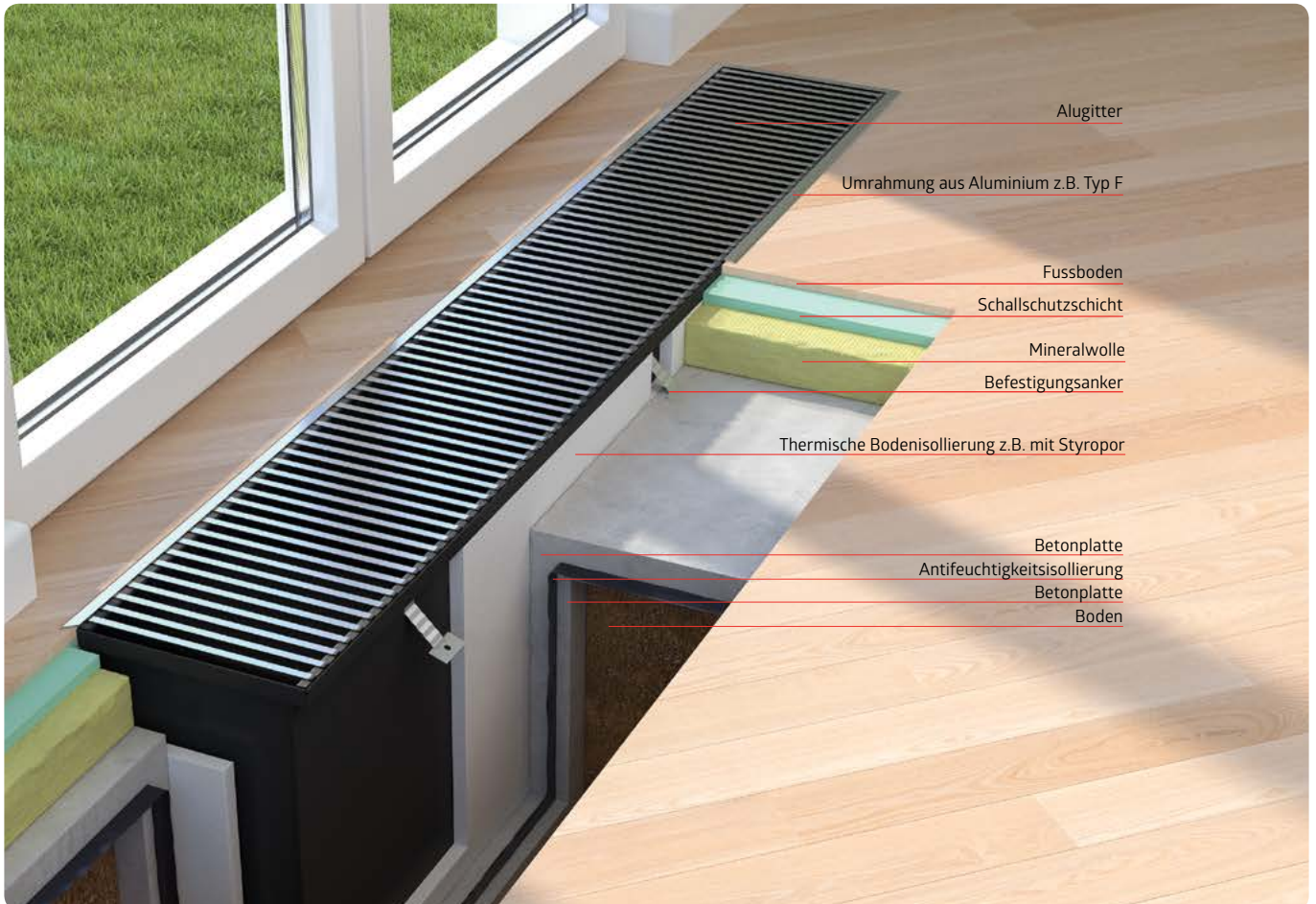
Beispiel für die Montage einer tiefen Kanalheizung
