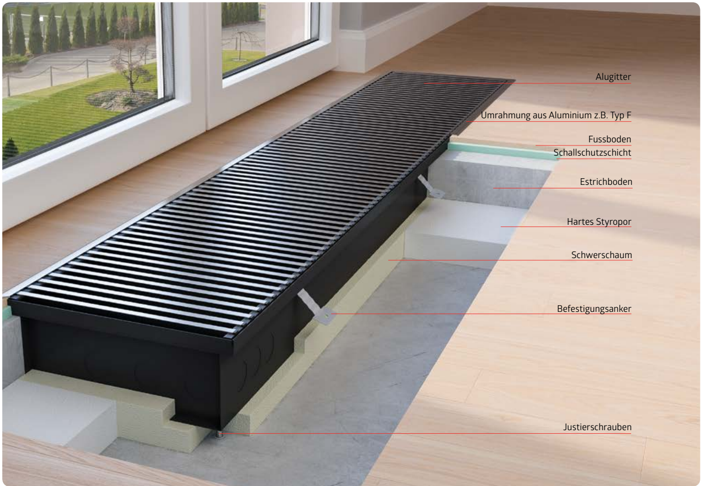
Beispiel für die Montage einer flachen Kanalheizung
